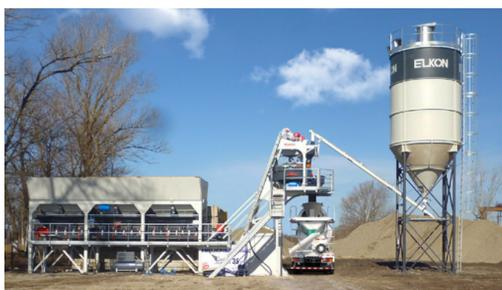
Еще один завод будет установлен в Западно-Казахстанской области. Кроме увеличенных до 60 куб.м линейных бункеров для инертных материалов, которые также оборудованы дополнительными элементами для работы в зимнее время, БСУ укомплектован парогенератором для подачи теплой воды в дозатор и горячего пара в регистры отопления. Для завода было применено специальное решение — система подачи цемента из мешков посредством шнека сразу в дозатор цемента.
